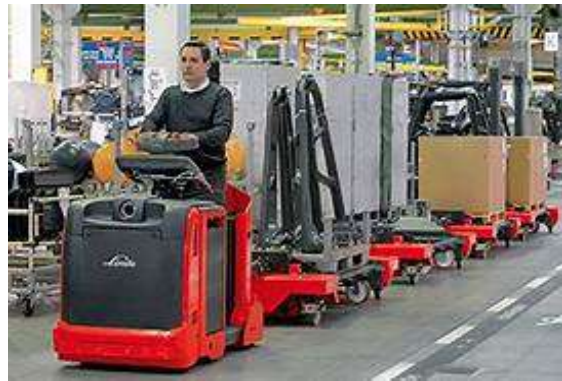
Typ 6 Fahrerloses Transportsystem
