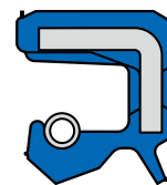
Bauform BA..SL Bauform AS nach DIN / ISO Haftteil glatt
