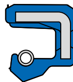
Bauform BA.. Bauform A nach DIN / ISO Haftteil glatt
