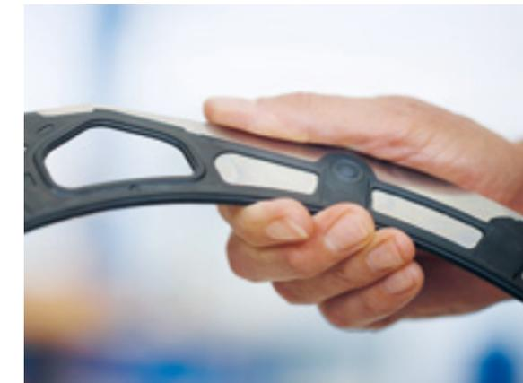
Rechts: Dieser Prüfkörper dient zur Kontrolle der Bindung zwischen Kunststoffen und Elastomeren, die bei Elektrolyseuren mit thermoplastischen Rahmen zum Einsatz kommt.
