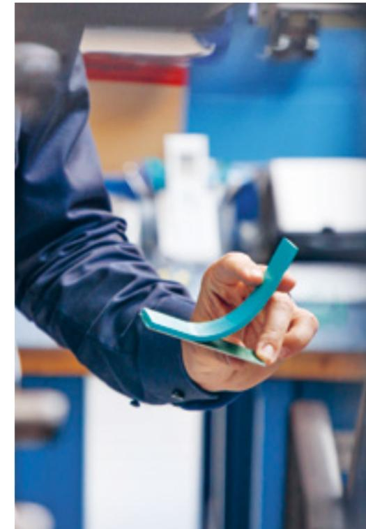
Links: Anhand dieses Prüfkörpers wird kontrolliert, ob die Elastomere richtig mit der metallischen Trägerplatte verbunden sind.
