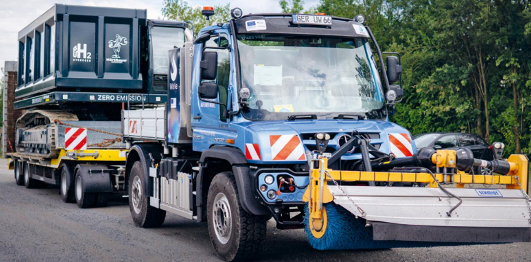
eine Weiterentwicklung der bekannten Verbrennungstechnologie und wird für anspruchsvolle Anwendungen als mittel- und langfristige Lösung zur Emissionsreduzierung wahrgenommen. Daher sind Produkte für die Wasserstoffverbrennung fester Bestandteil unserer Wasserstoffstrategie.“ Die Ausgangsposition ist vorzüglich: Das Unternehmen hat jahrzehntelange Erfahrung in der Entwicklung und Produktion der vielen unterschiedlichen Dichtungskomponenten für Gasverbrennungsmotoren.
