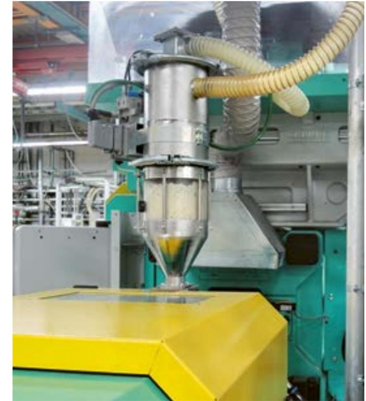
Rechts: Das unter den perfekten Bedingungen gelagerte Granulat gelangt in die Spritzgussmaschine.
