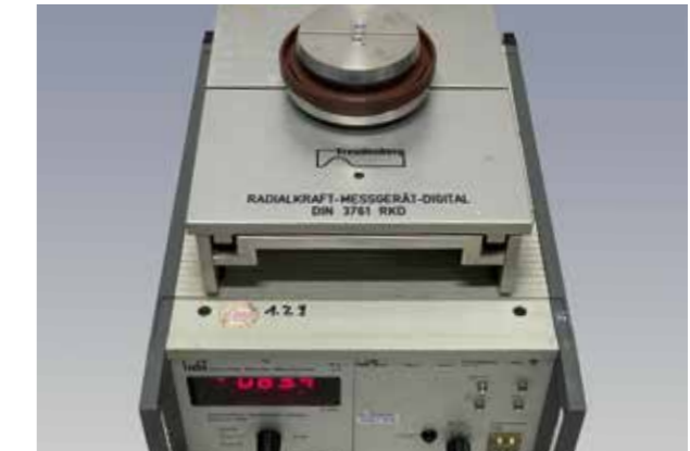
Radialkraftmessung eines Radial-Wellendichtrings
