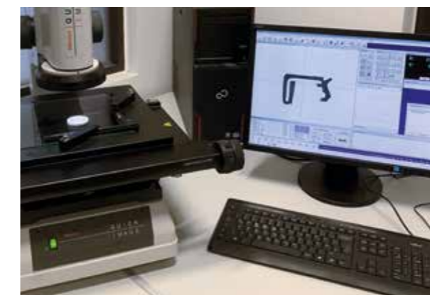
Profilquerschnittsprüfung eines Radial-Wellendichtrings
