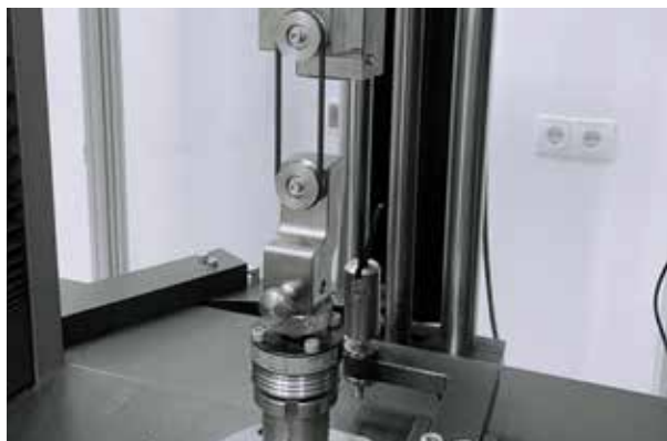
Zugprüfung an Fertigerzeugnis O-Ring
