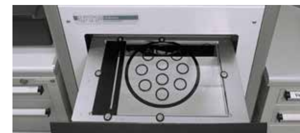
Dimensionale, berührungslose Prüfung mittels optischer Messmaschinen
