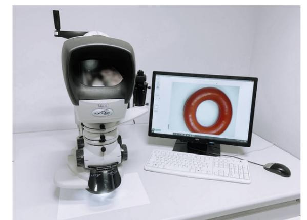
Oberflächenprüfung mit digitalem Mikroskop
