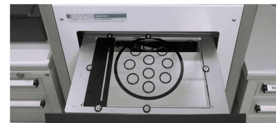
Dimensionale, berührungslose Prüfung mittels optischer Messmaschinen
