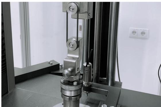
Zugprüfung an Fertigerzeugnis O-Ring
