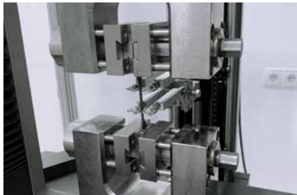
Zugprüfung an einem Normprobekörper
