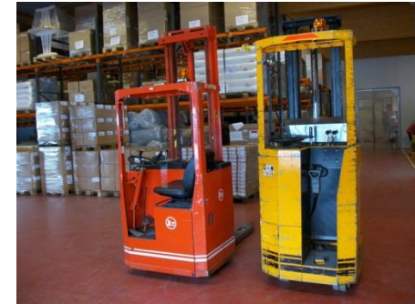
Typ2: Seitsitzstapler, Schubmaststapler, Fahrerstandstapler
