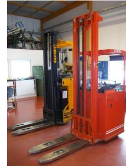
Typ2: Seitsitzstapler, Schubmaststapler, Fahrerstandstapler
