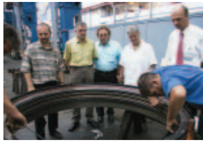
Bis zu 1,50 m im Durchmesser sind die Simmerringe groß, die in den Schiffspropellern von Voith-Schneider allen Anforderungen stand halten.
