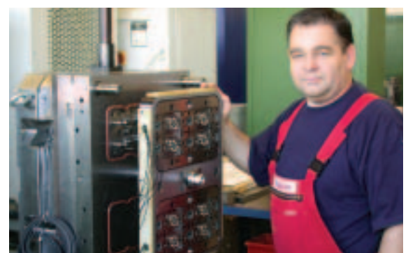
Die Qualität des Werkzeugs ist entscheidend für die Qualität der Produkte. Detlef Malze am 2-K-Werkzeug.
